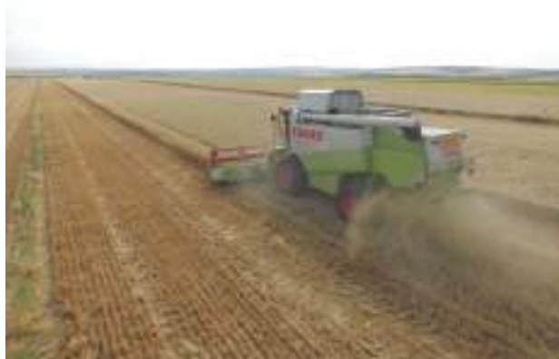
Imagen 2. Vista de las parcelas de trigo en la finca de Lebrija en el momento de la cosecha. Se puede observar cómo en la parcela manejada en siembra directa, la cosechadora pica y esparce la paja y granzas.
