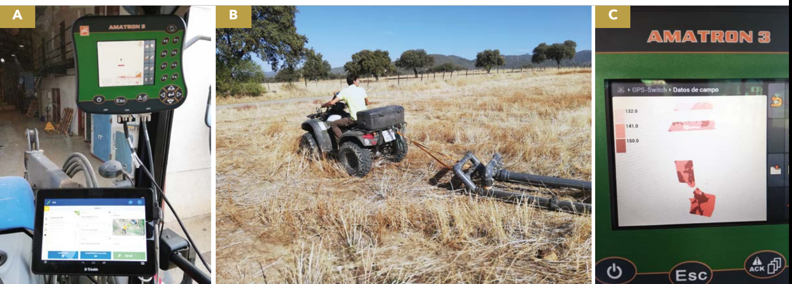
Figura 2. Sistema de guiado automático en tractor y controladores de maquinaria (A), sensor para la medida de la conductividad eléctrica del terreno para hacer mapas de distribución variable de insumos (B), mapa de distribución variable de abono (C) en la Finca Experimental.
